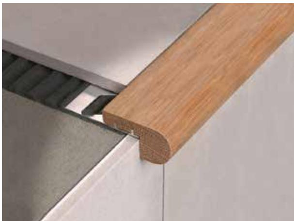
STAIRTEC FW est un nez de marche en bois naturel massif supporté par une structure angulaire en aluminium perforé qui en assure un bon encollage ainsi que la stabilité de l'ensemble. Sa forme simple et ses dimensions le rendent utilisable pour toutes sortes d'ambients, modernes et traditionnels. Idéal pour application sur escaliers domestiques, il peut être utilisé aussi pour compléter les plans de travail de cuisines carrelés.
